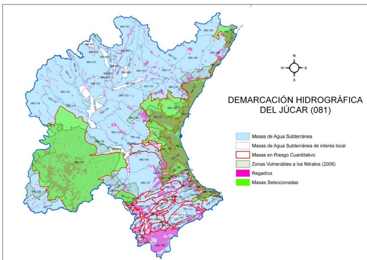
Figura 4.- Selección de MASb por la aplicación del Criterio Zonas Vulnerables a los Nitratos en la Demarcación Hidrográfica del Júcar
